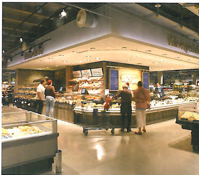
Die Kassentische und Bedienungstheken im E-Center St. Pauli sind mit kunststoffbeschichteten Spanplatten in Holzoptik verblendet
